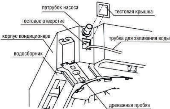
Включите питание, запустите агрегат в режиме охлаждения ("COOLING"). Прислушайтесь к звуку дренажного насоса. Убедитесь в правильном выходе воды (допустима задержка в 1 мин перед выходом, в зависимости от длины дренажного трубопровода) и в отсутствии протечек. Внимание:
