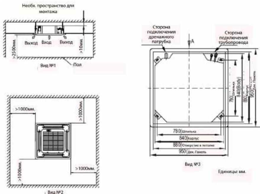
с. Выровняйте шестиугольные гайки четырех монтажных крюков для обеспечения балансировки корпуса.
